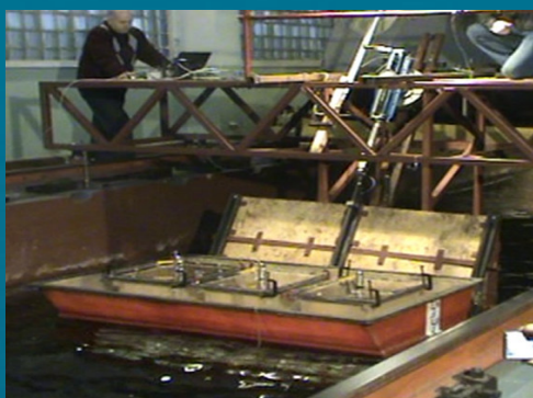
Испытания рабочего органа ВлЭС с электрическим генератором.
